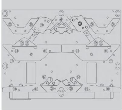
全电机控制的直选针三角系统，结构简单，尺寸紧凑、轻巧
