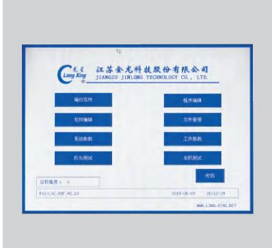
采用LED触摸屏，可显示各种编织相关参数
